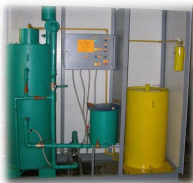
Рисунок 18 - Пример лабораторной биогазовой установки
