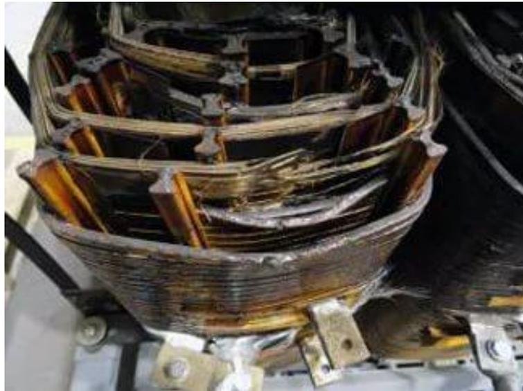
Рисунок 14 – Поврежденные обмотки силового трансформатора
