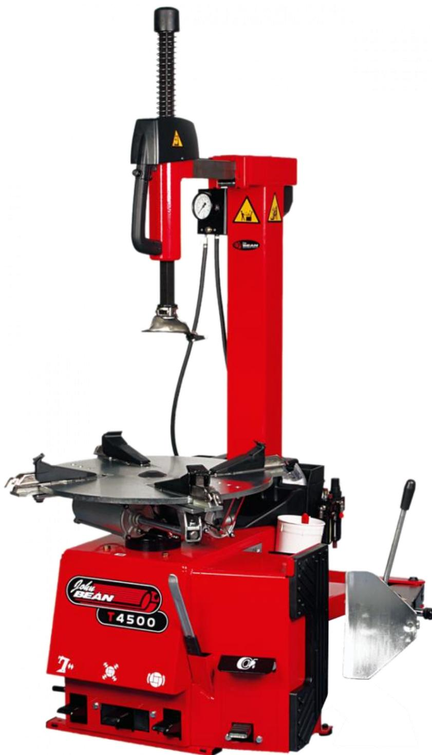
Рисунок 2.3 – Шиномонтажный стенд JOHN BEAN T4500
