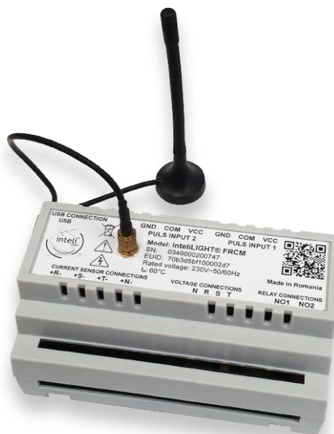
Рисунок 28 - FRCM - блок управления и контроля панели освещения
