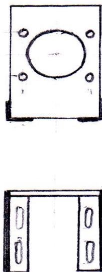
Рисунок 2.8 - Станина крепления насоса
