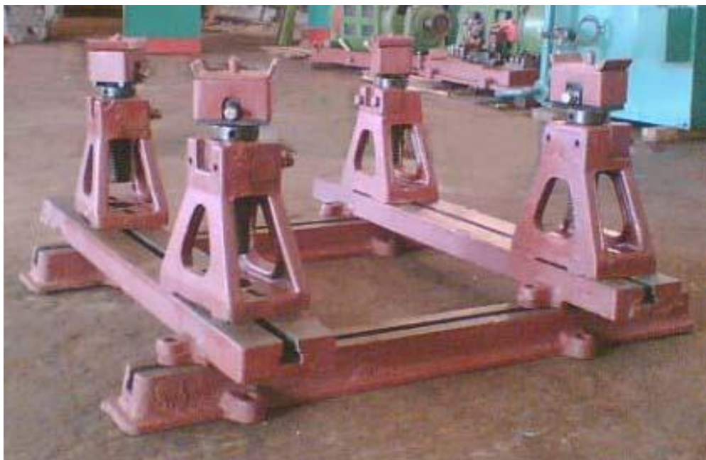
Рисунок 2.5 - Отдельное расположение стоек и направляющих платформ.
