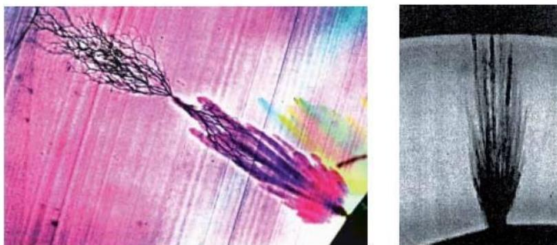
Рисунок 1.1 - Развитие триинга в кабеле из сшитого полиэтилена
