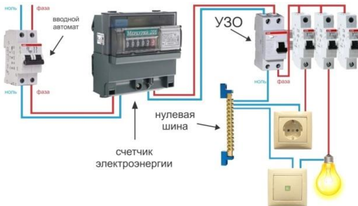
Рисунок 21 - Схема подключения УЗО
