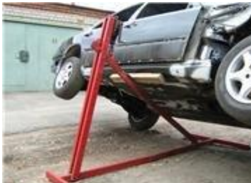
Рисунок 2.4 – Рабочее положение автомобиля на подъемнике УМС-2
