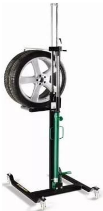
Рисунок 2.2 Монтажно-транспортная тележка I-16 для работы с малогабаритными колесами
