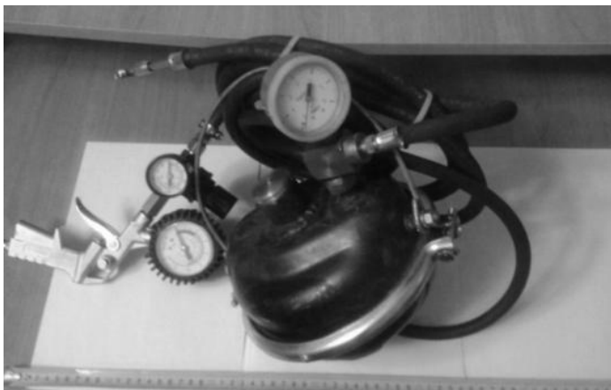
Рисунок 2.2 - Установка для прокачки тормозной системы
