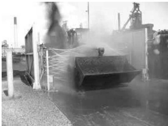
Рисунок 2.2 - Системы мойки колес тяжелой техники
