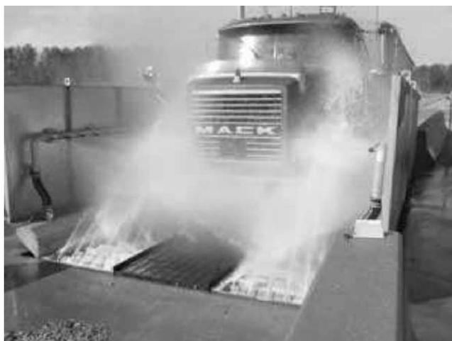
Рисунок2.1- Стационарная моющая система Tire Wash SERIES
