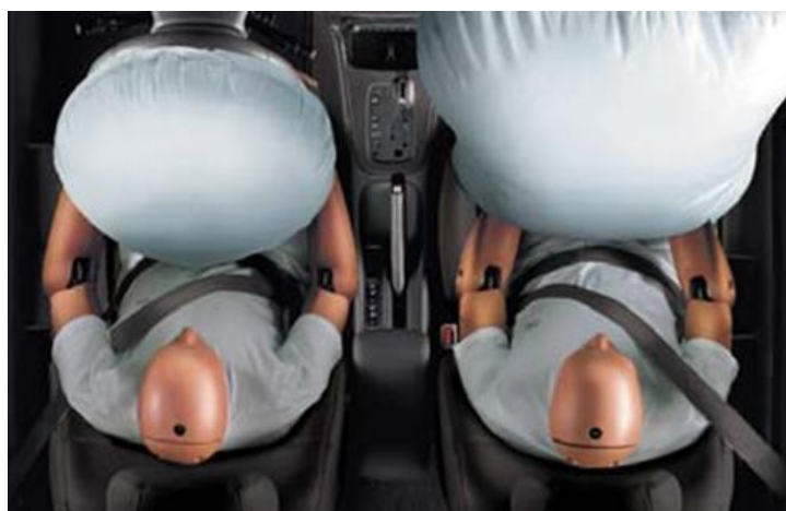
Рисунок 2.11 - Подушки безопасности(вид сверху)
