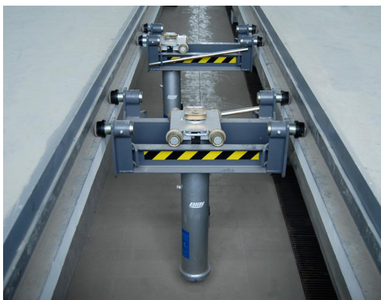
Рисунок 2.3 Элементы гидropодъемника ремонтного отделения
