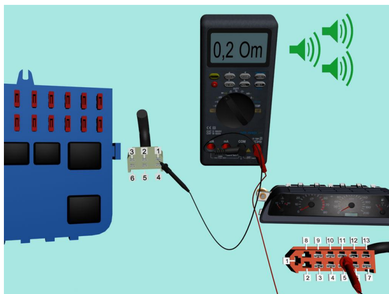
Рисунок 2.14 – "Прозвонка" провода мультиметром
