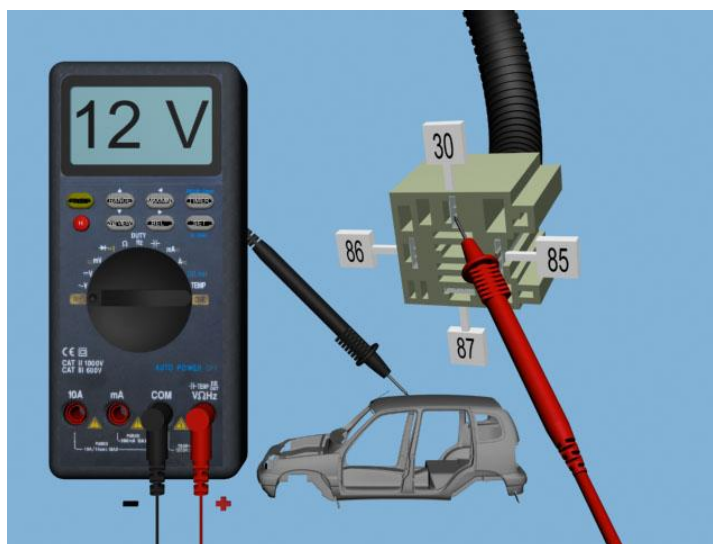
Рисунок 2.22 – Проверка 30-го контакта колодки реле мультиметром
