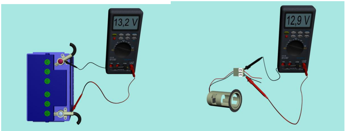
Рисунок 2.16 – Проверка падения напряжения в какой-либо точке проводки
