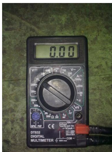
Рисунок 2.15 – Режим мультиметра для замера напряжения постоянного тока
