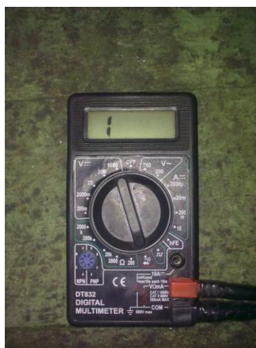
Рисунок 2.13 – Режим мультиметра для "прозвонки" электрической цепи
