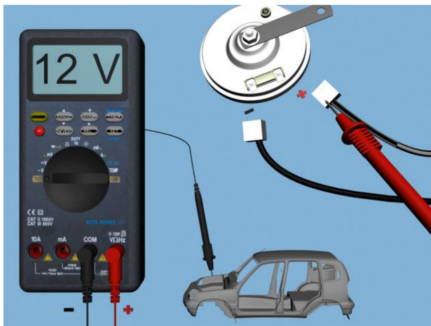
Рисунок 2.29 – Проверка серо-черного провода мультиметром
