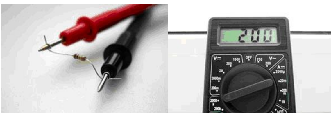
Рисунок 2.12 – Измерение резистора с номиналом 200 кОм.
