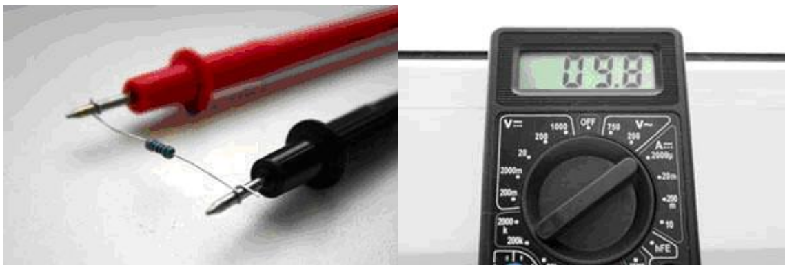
Рисунок 2.11 – Измерение резистора с номиналом 10 кОм.
