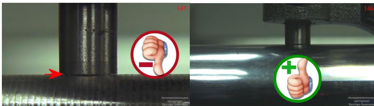
Рисунок 3.30 – Пример влияния шероховатости детали на достоверность измерения
