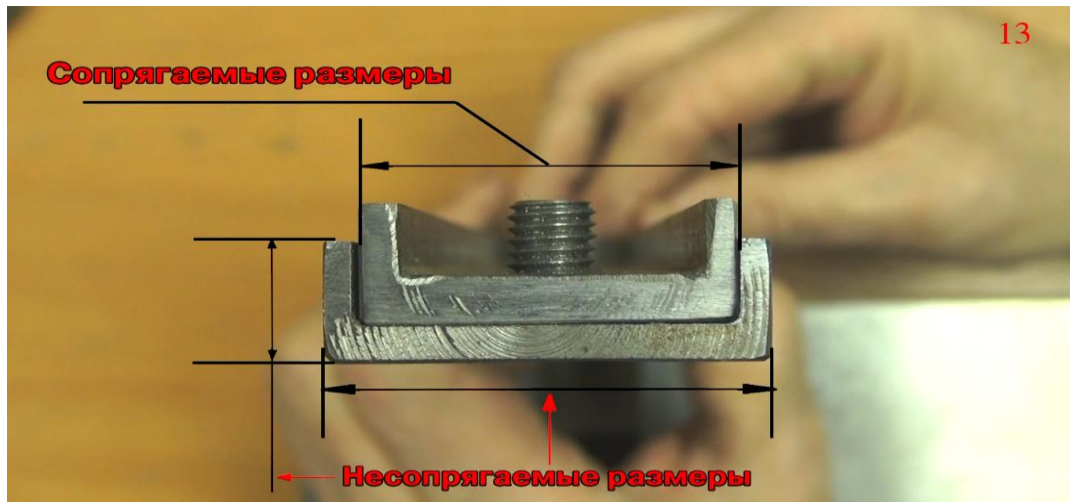
Рисунок 3.34 – Пример сопрягаемого и несопрягаемого размера
