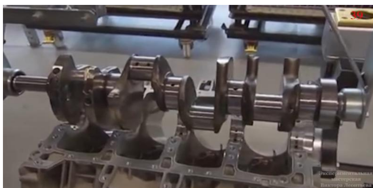
Рисунок 3.39 – Пример сопряжения коренной шейки коленчатого вала с вкладышем
