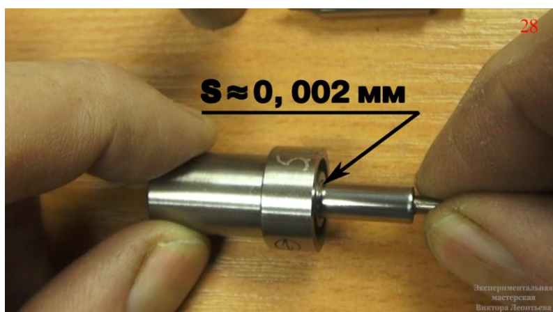
Рисунок 3.37 – Пример посадки с зазором между деталями плунжерной пары
