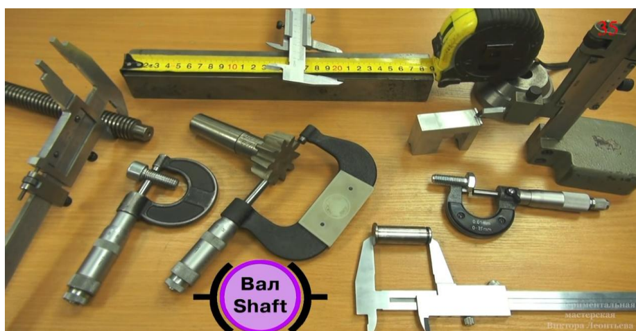
Рисунок 3.9 – Примеры измерений диаметров цилиндрических деталей и расстояний между двумя поверхностями нецилиндрических деталей
