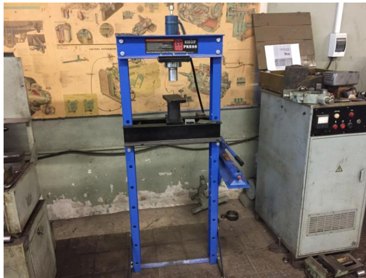
Рисунок 2.1 – Гидравлический пресс с усилием 20 тонн
