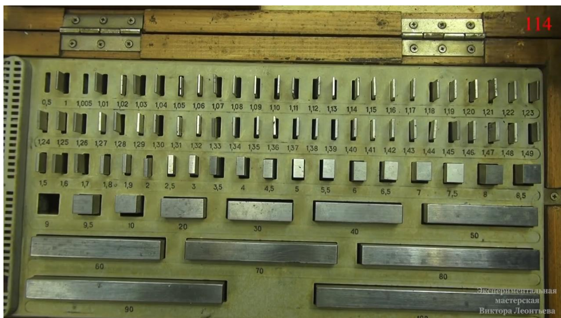
Рисунок 3.25 – Концевые меры длины или мерные плитки
