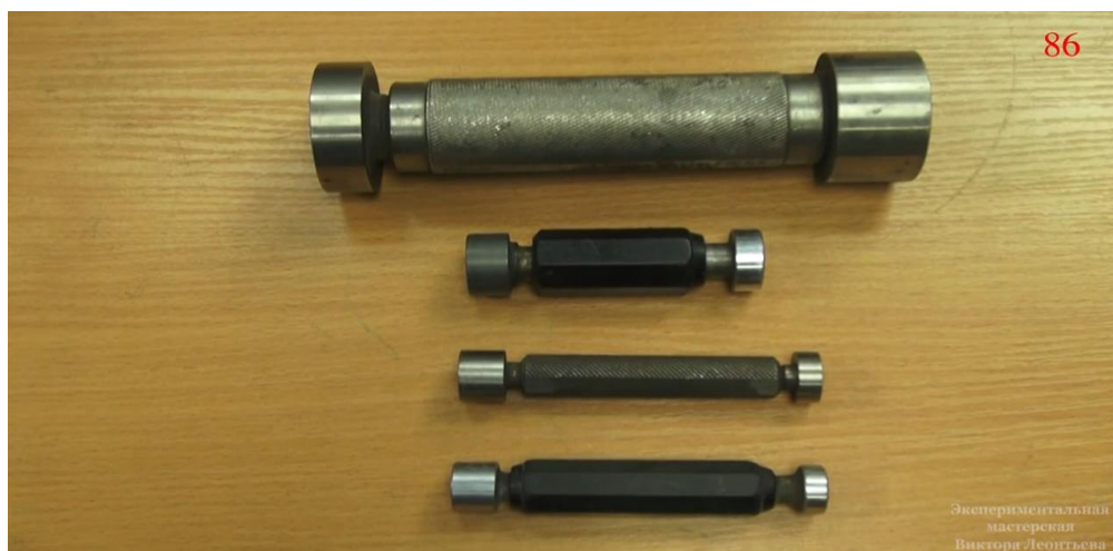
Рисунок 3.21– Измерительные приборы (Калибры)
