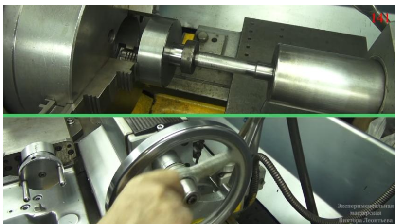
Рисунок 3.60 – Запрессовка посадки винтовым прессом
