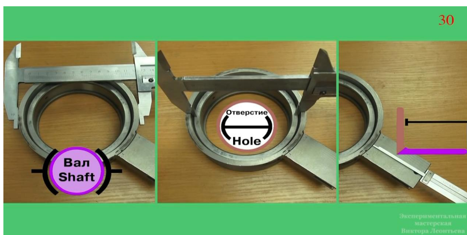
Рисунок 3.7 – Примеры измерений диаметров валов, отверстий и глубины деталей
