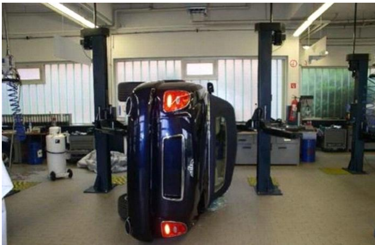
Рисунок 17 – Падение автомобиля с подъемника
