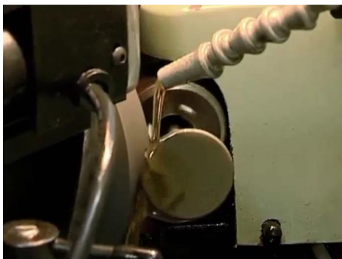
Видеоролик 2 – Механическая обработка клапана и седла клапана
