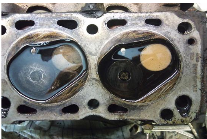
Рисунок 30 – Керосин в камерах сгорания
