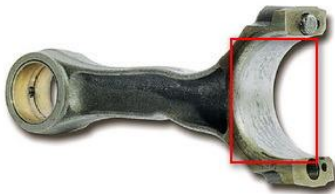
Рисунок 21 - задиры на рабочей поверхности нижней головки шатуна
