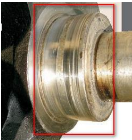
Рисунок 24 – Износ торцевой поверхности коленчатого вала
