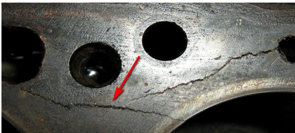
Рисунок 16 – Трещина блока цилиндров
