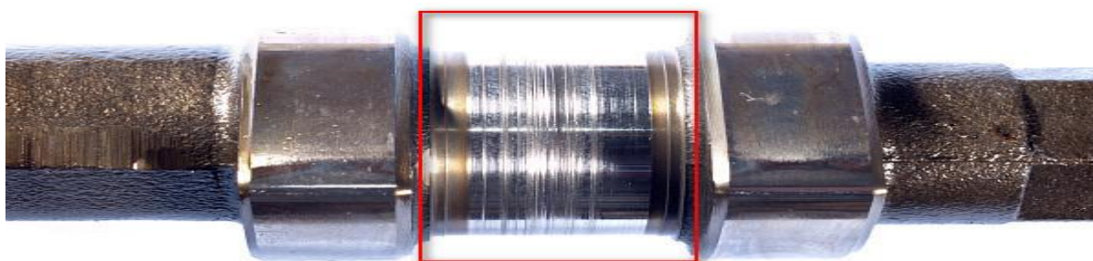
Рисунок 10 – Задиры на опорной шейке распределительного вала
