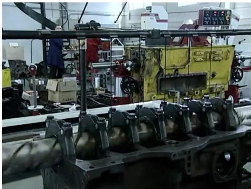
Видеоролик 5 – Расточка и хонингование постелей коленчатого и распределительного валов
