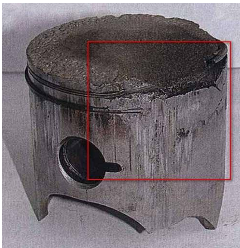
Рисунок 17 – Повреждения верхней части поршня
