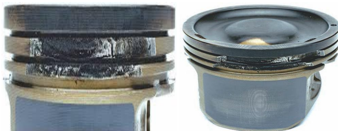
Рисунок 20 - Разрушение перемычек между канавками под поршневые кольца
