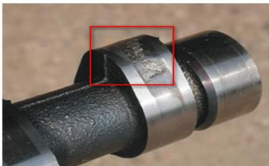
Рисунок 11 – Задиры на рабочей поверхности кулачков
