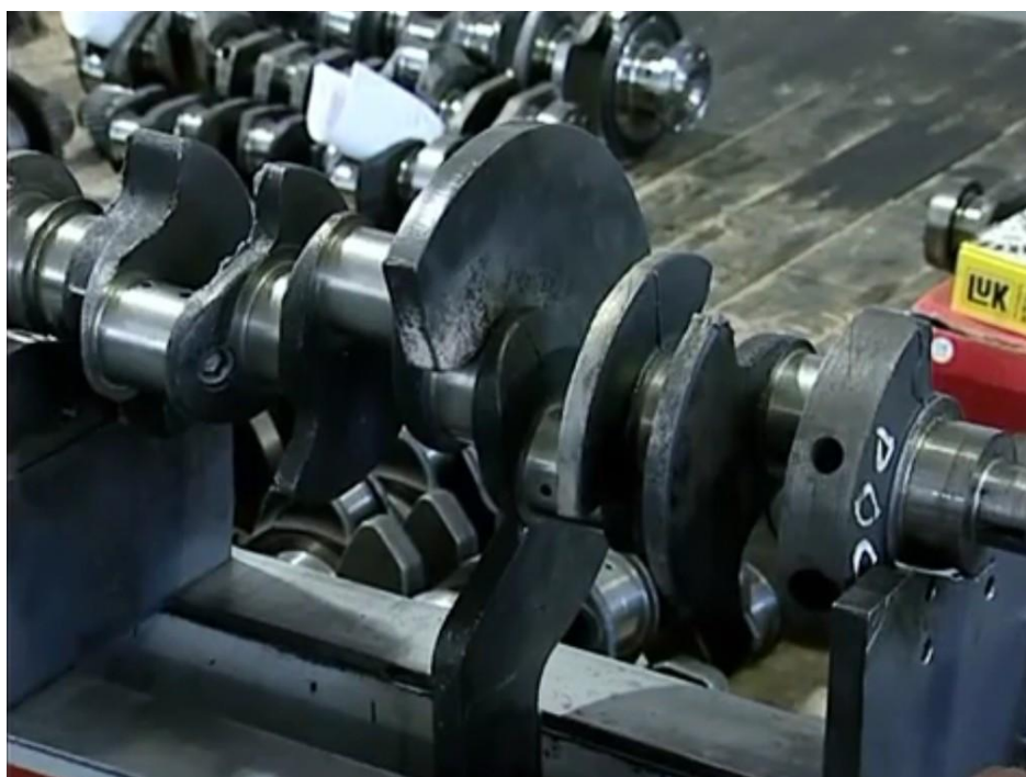
Видеоролик 6 – Правка коленчатого вала
