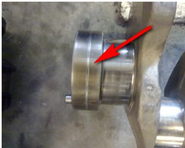
Рисунок 26 – Выработка поверхности под сальники
