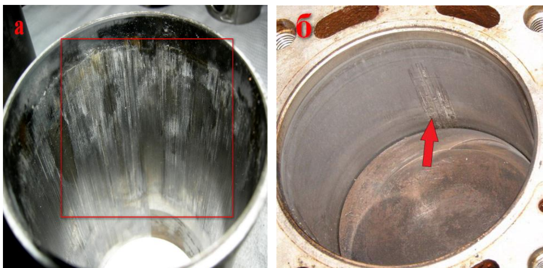
а – задиры, возникшие при перегреве двигателя; б – задиры, возникшие при нарушении фиксации поршневого пальца
