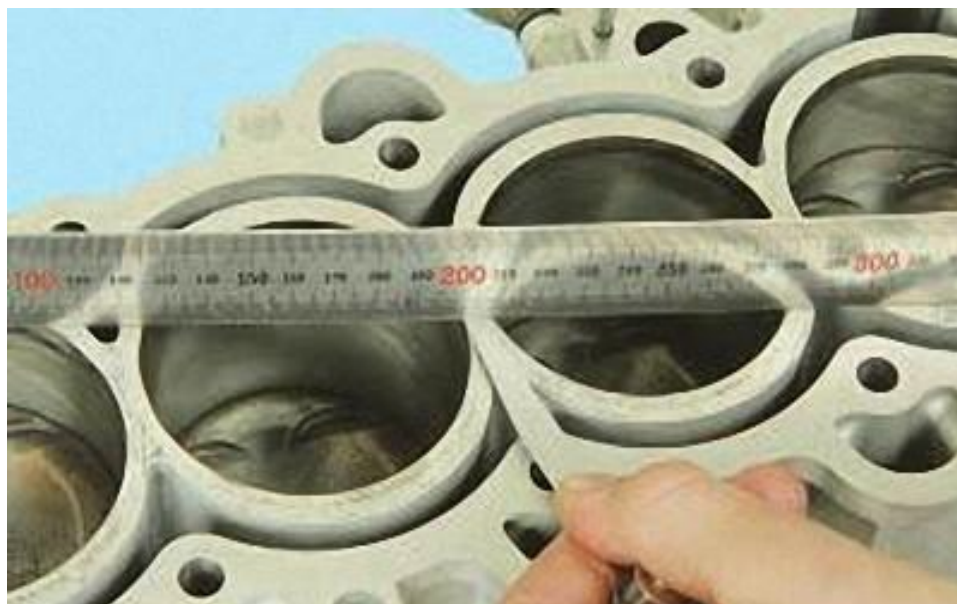
Рисунок 33 - Проверка деформации привалочной плоскости блока цилиндров
