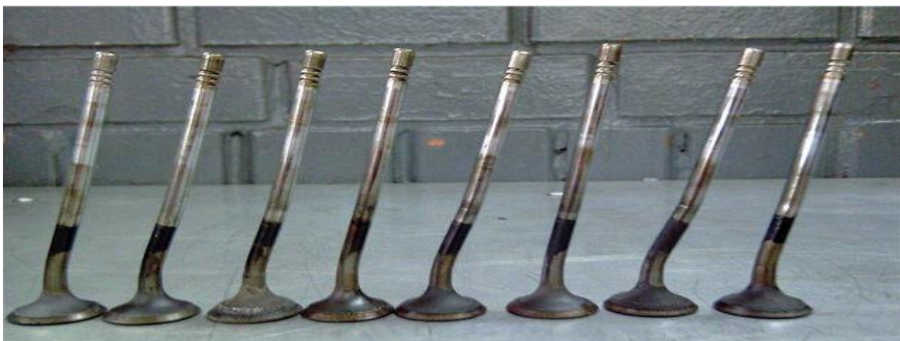
Рисунок 7 – Изгиб стержня клапана
