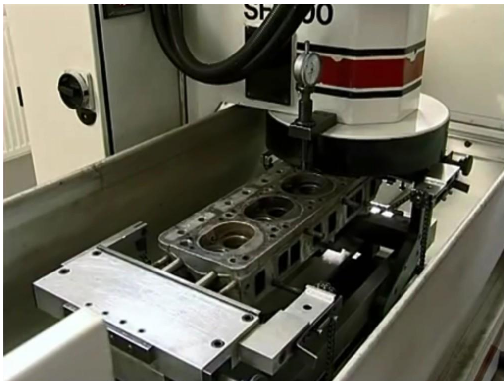
Видеоролик 3 – Шлифовка привалочной плоскости головки блока цилиндров
