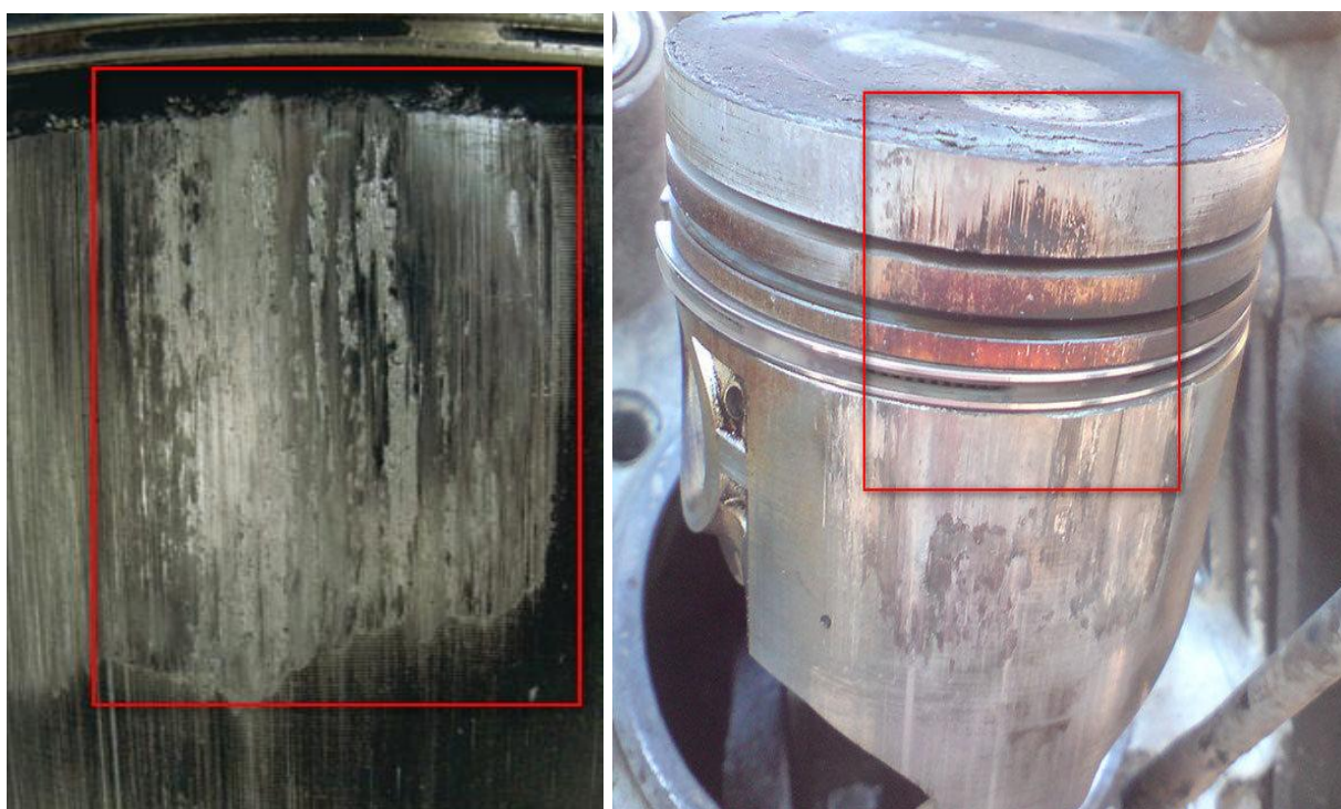
Рисунок 18 – Местные задиры на поршне
