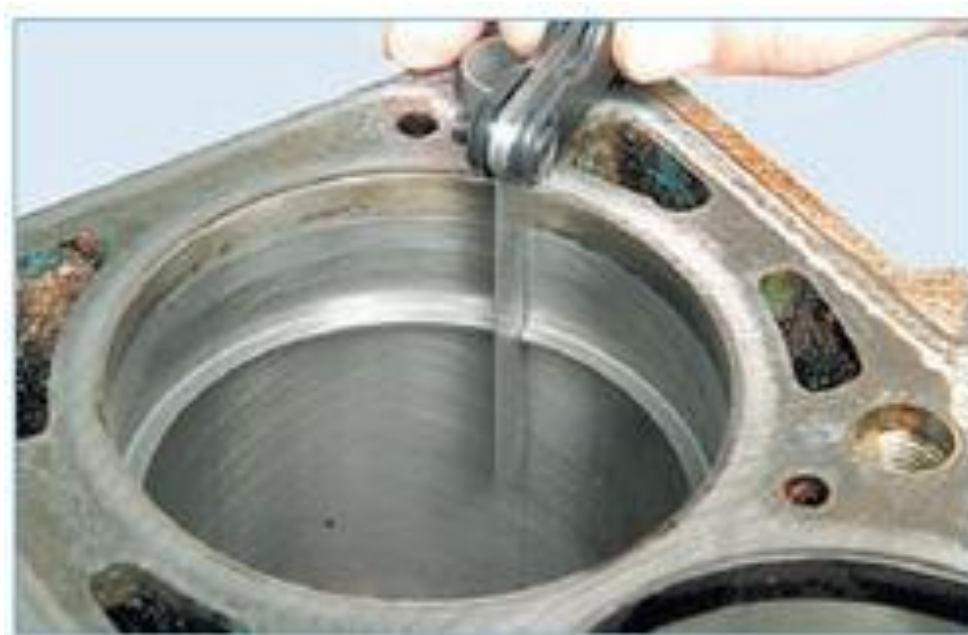
Рисунок 40 – Проверка зазора в замке кольца
