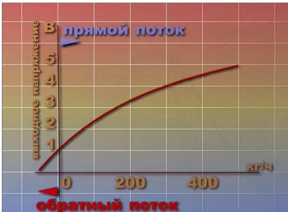
Рисунок 12 – Зависимость напряжения на выходе ДМРВ от количества проходящего воздуха
