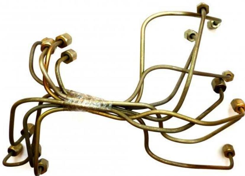
Рисунок 6 – Трубопроводы высокого давления
