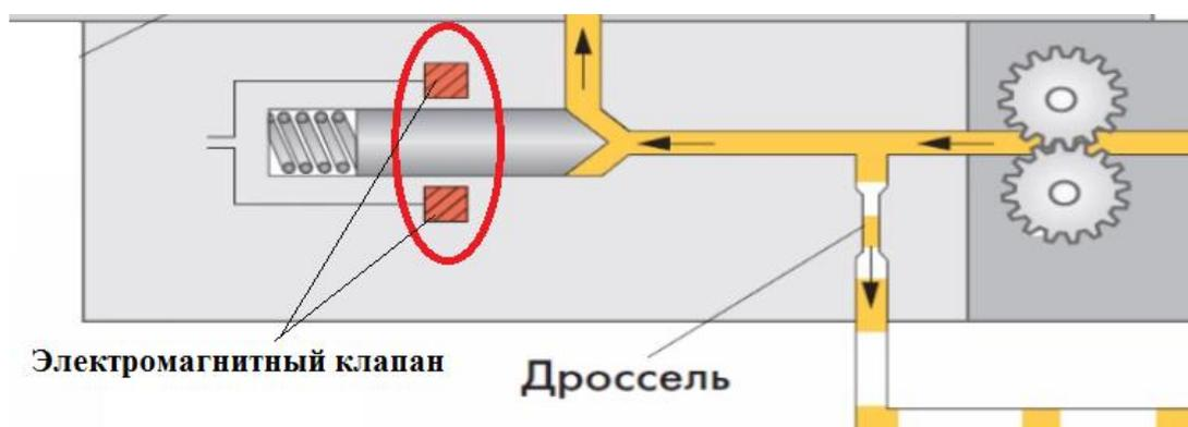
Рисунок 23 – Электромагнитный клапан
