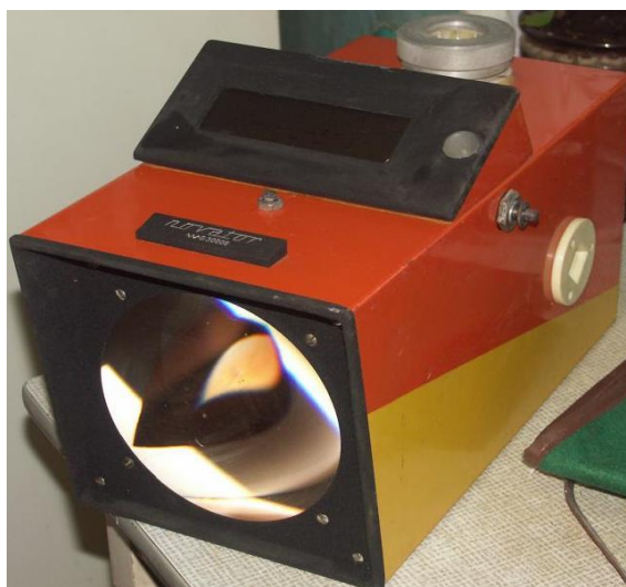
Рисунок 12 – Измерительная головка с оптической камерой фирмы Novator
