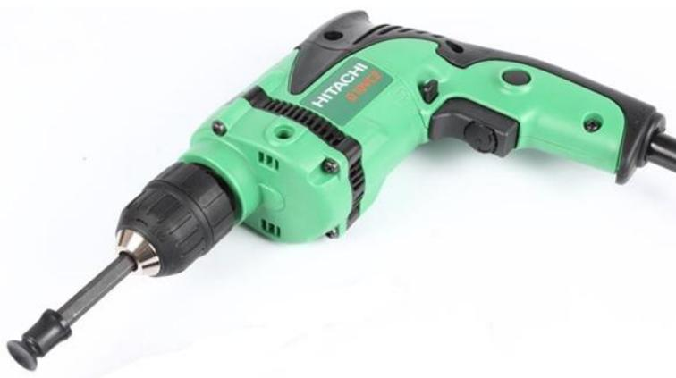
Рисунок 2.1 - Притирка клапана с помощью насадки на дрель.
