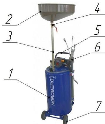
1 – емкость, 2 – воронка, 3 – трубка, 4 – кран, 5 – ручка, 6 – зонды для откачки масла,
