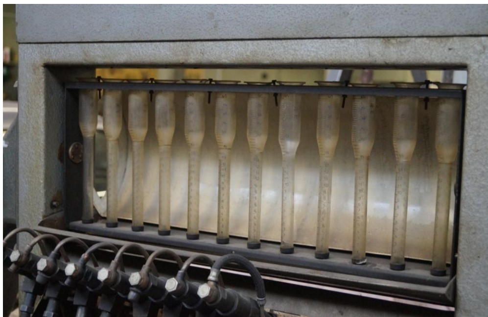
Рисунок 18 – Равномерность подачи топлива секциями ТНВД
