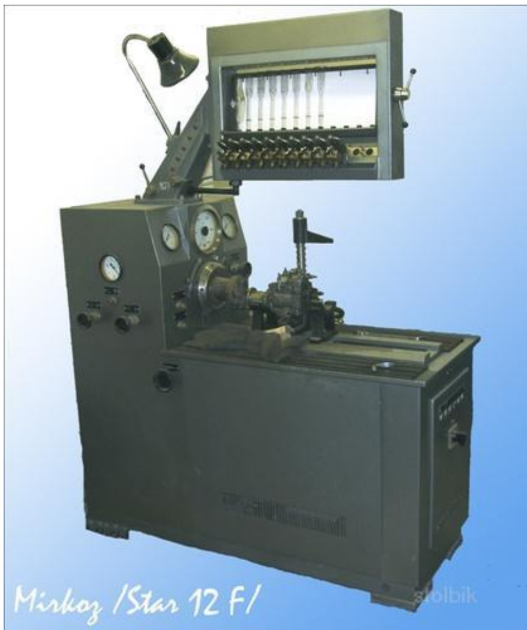
Рисунок 1 – Стенд для диагностирования ТНВД
