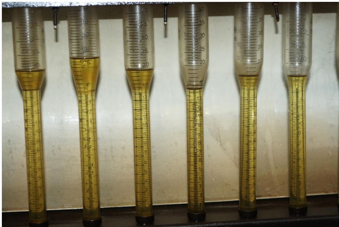
Рисунок 3 – Неравномерность подачи топлива
