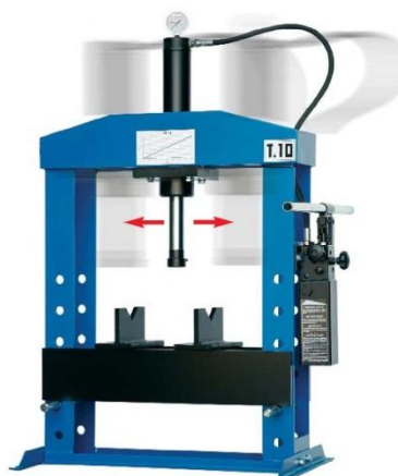
Рисунок 2.5 - Пресс настольный 10 т, ф. ОМА, модель 650 (Италия)
