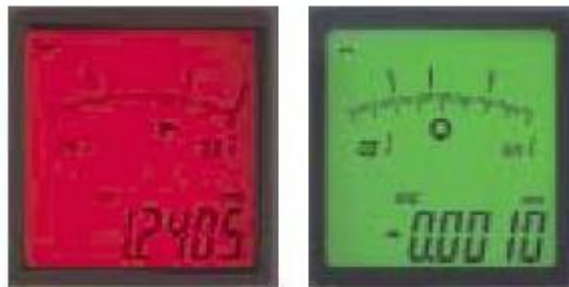
Рисунок 3.4 - Цветовая индикация превышения пределов допуска
