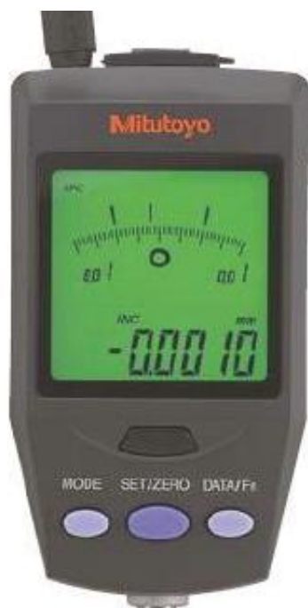
Рисунок 3.2 - Цифровая измерительная головка ID-N
