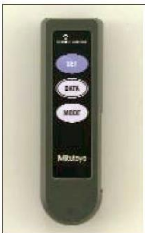
Рисунок 3.3 - Пульт дистанционного управления 21EZA099
