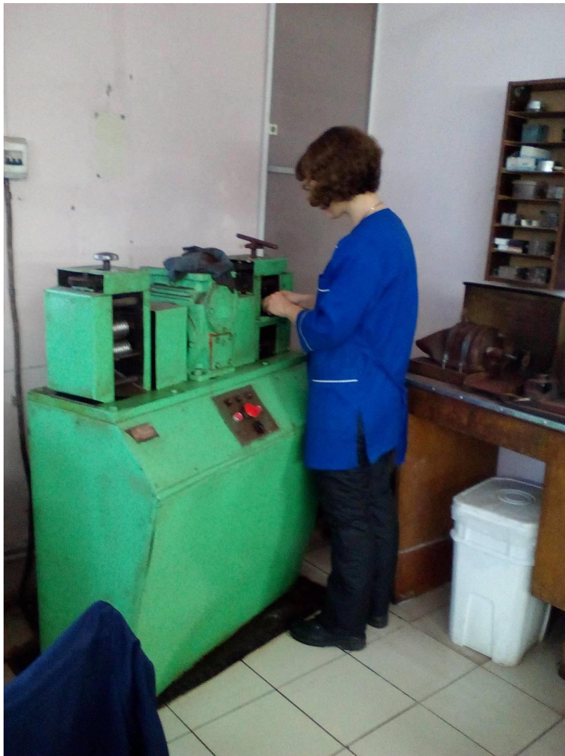
Рисунок Д.7 — Фотография отображает процесс изготовления листового проката. Процесс выполняется автором спроектированного ювелирного комплекта «Свет души».
