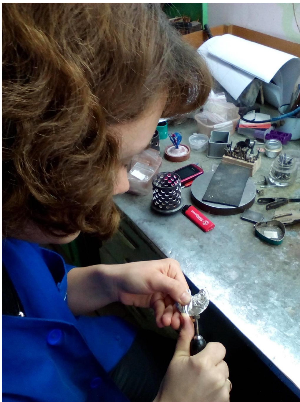
Рисунок Д.3 — Фотография отображает процесс шлифовки и подгонки отлитой в металле модели. Процесс выполняется автором спроектированного ювелирного комплекта «Свет души».
