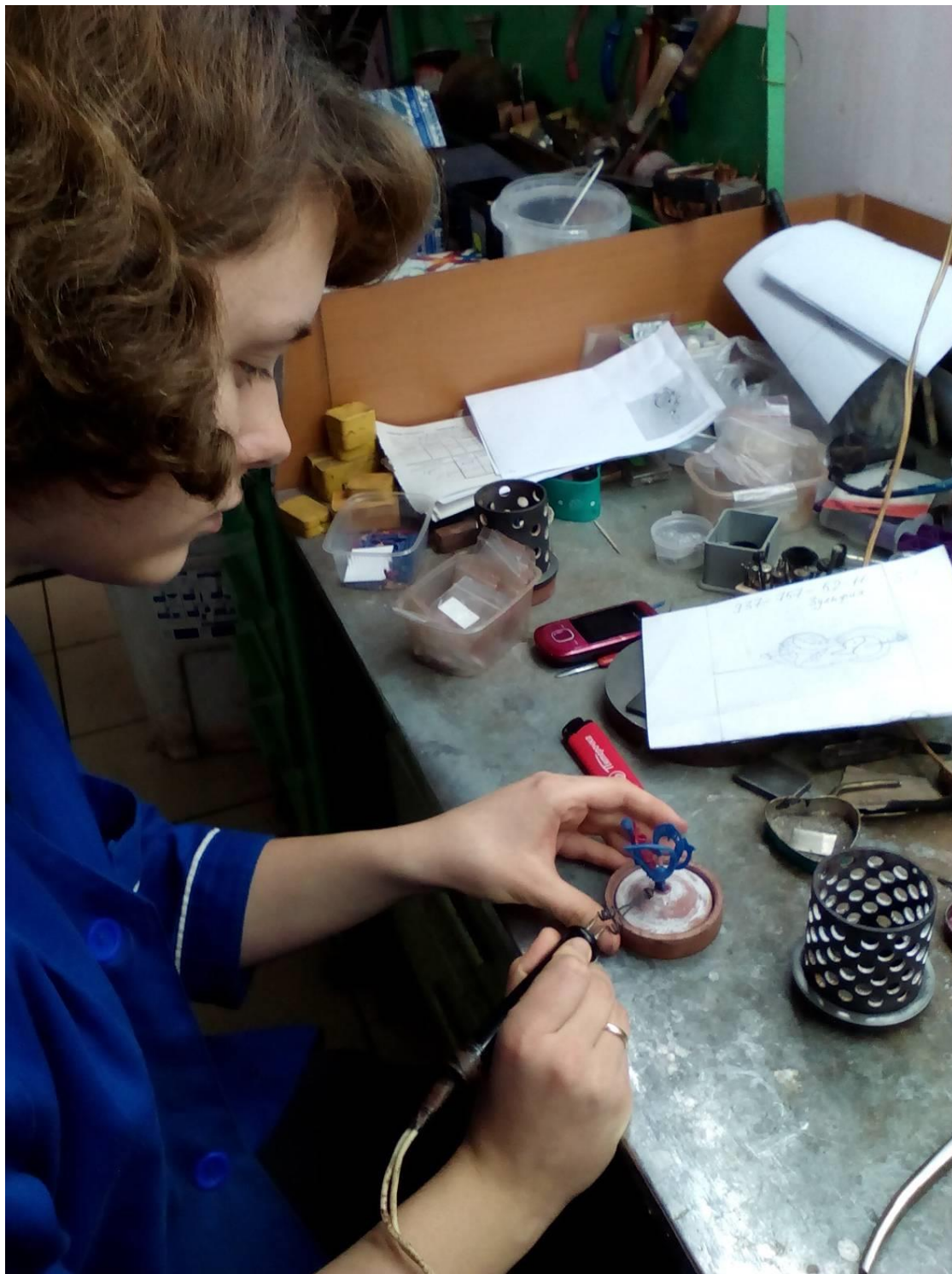
Рисунок Д.2 — Фотография отображает процесс сборки восковой литниковой системы. Процесс выполняется автором спроектированного ювелирного комплекта «Свет души».
