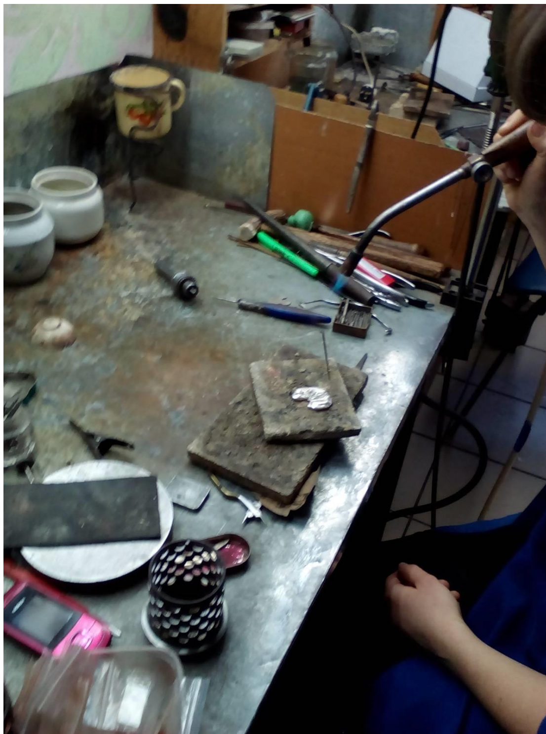
Рисунок Д.4 — Фотография отображает процесс отжиг детали изделия. Процесс выполняется автором спроектированного ювелирного комплекта «Свет души».
