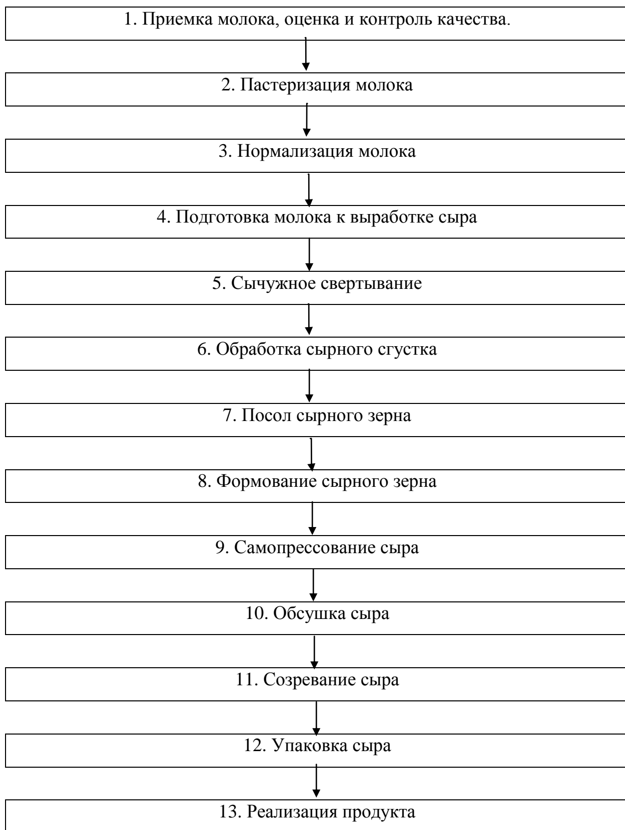
Рисунок 3.2.1- Технологический процесс производства мягкого сыра- Брынза
