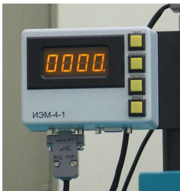
Рисунок 3.3 - Элементы управления на лицевой панели индикатора ИЭМ-4-1
