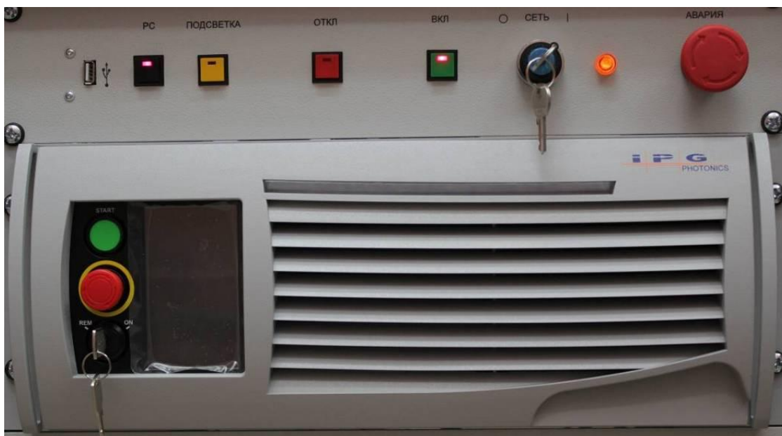
Рисунок 3.2 - Расположение элементов управления электропитанием машины ЛКД4-015
