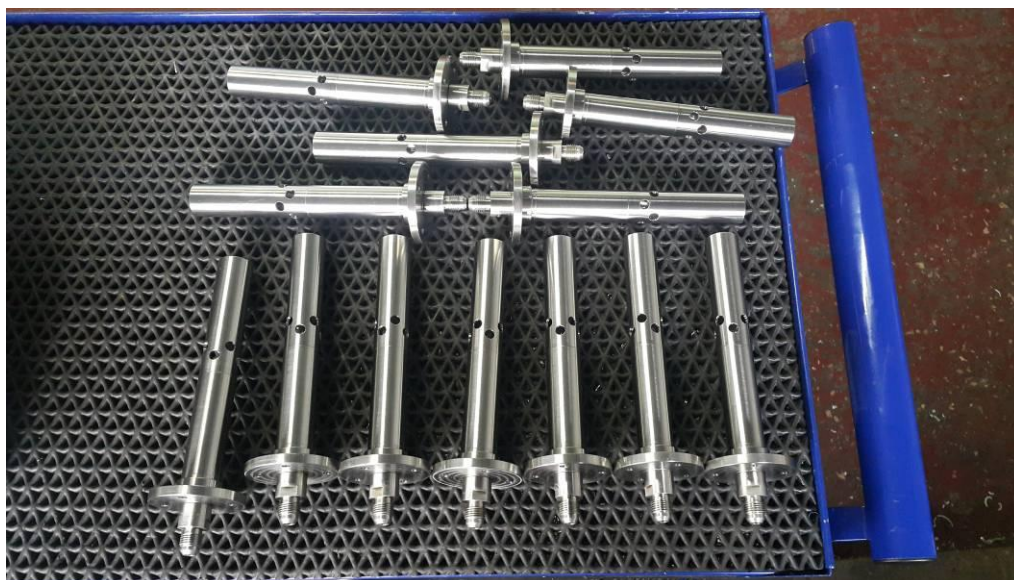
Рисунок 3.7 – Фото сваренных при помощи лазерной установки образцов форсунок
