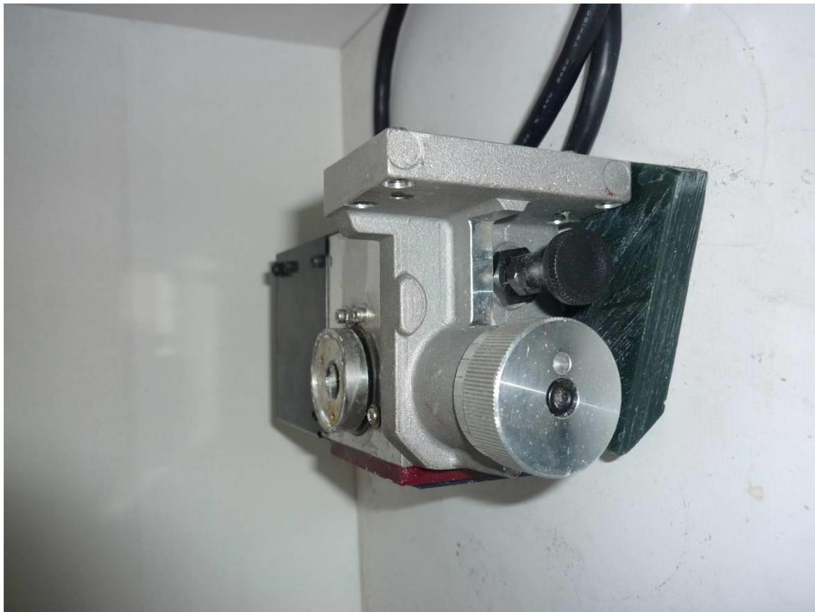
Оборудование, используемое автором при изготовлении бакалаврской работы. Поворотная ось ЧПУ станка.
