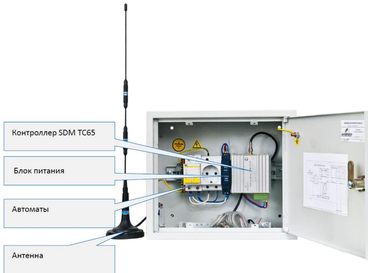
Рисунок 12 - Шкаф автоматизации АИИС с контроллером SDM TC65
