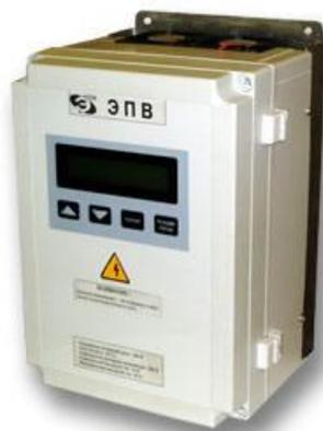
Рисунок 3.5- Внешний вид преобразователя
