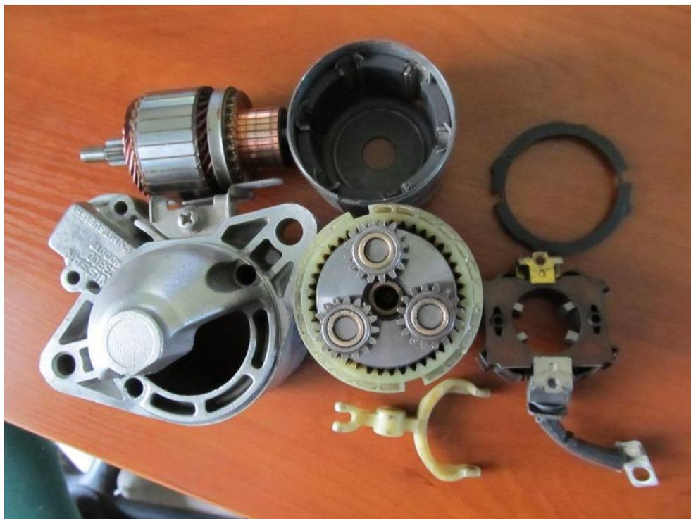
Рисунок 1.2- Детали автомобильного стартера
