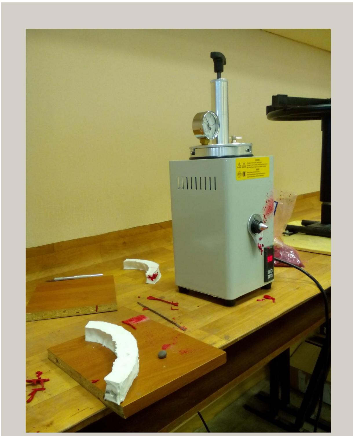
Рисунок К.1 Заливка воска через инжекторную установку – инжектор, резина.
