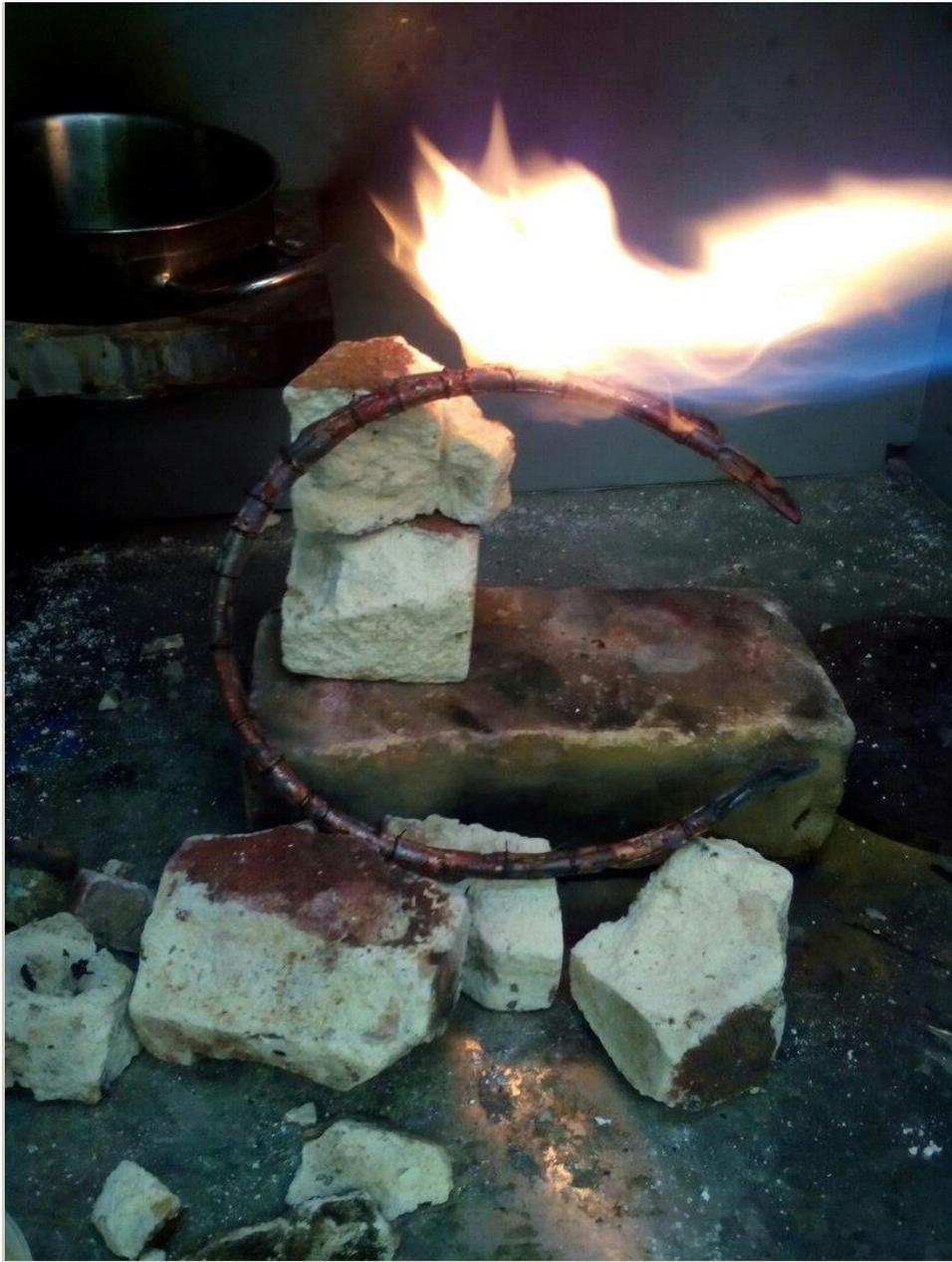
Рисунок П.1 – процесс пайки шейного украшения из ювелирной серии
