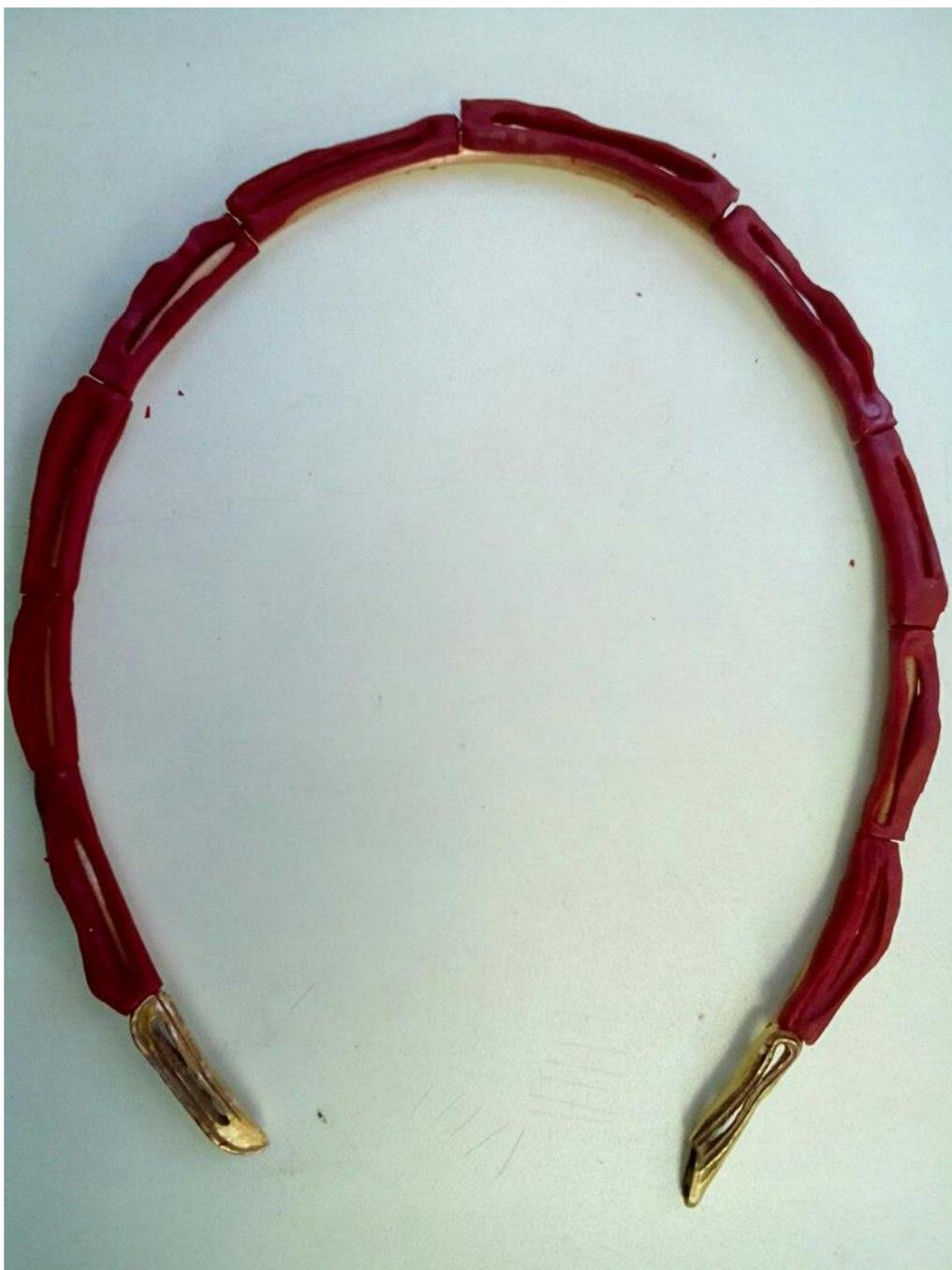
Рисунок Л.2 – Подгонка восковых моделей на металлическую основу
