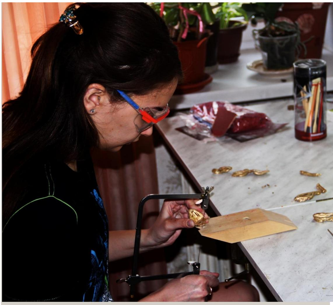
Рисунок Н.1 Отпиливание литниковых стержней – процесс отпиливания автором литников с изделий
