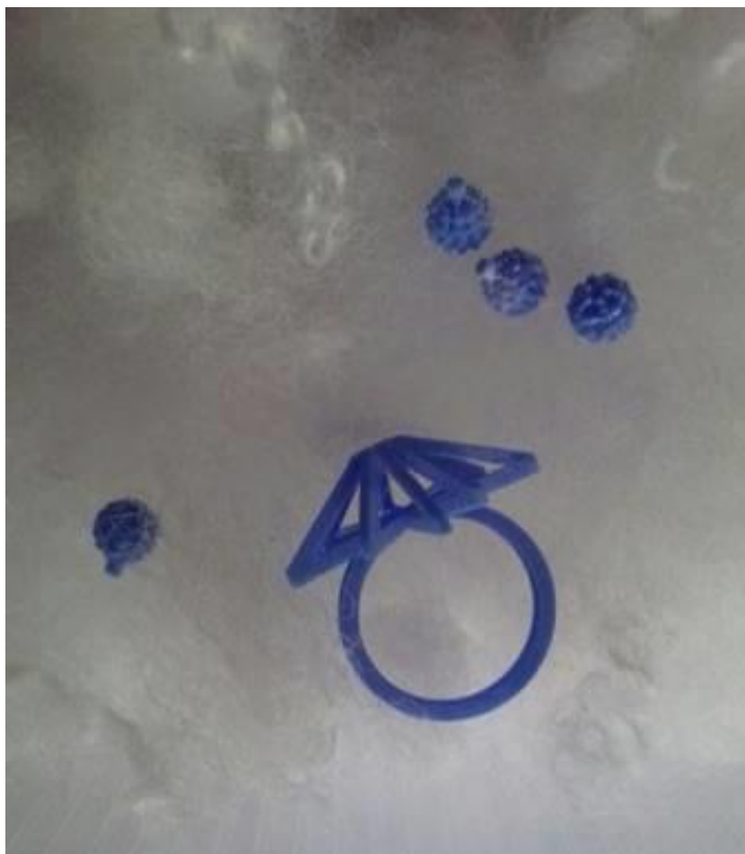
Рис. 27 3D-модели, выращенные из воска на 3D-принтере по заранее отстроенным файлам студентки Яковлевой Е.В.
