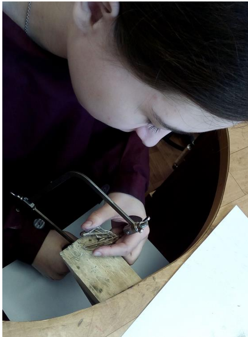
Рис. 30 Автор во время работы в мастерской: запечатлен процесс удаления литников. 2016г.
