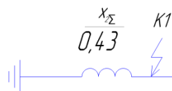
Рисунок 4.16 – Расчетная схема обратной последовательности для точки К1
