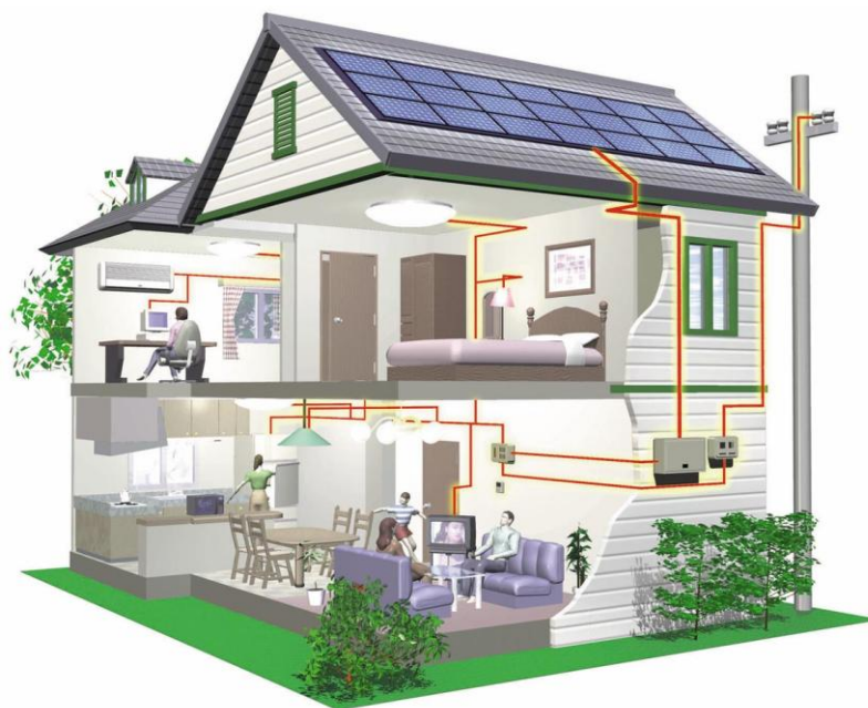
Рисунок 3.3 – Типовая электрическая схема включения солнечной батареи
