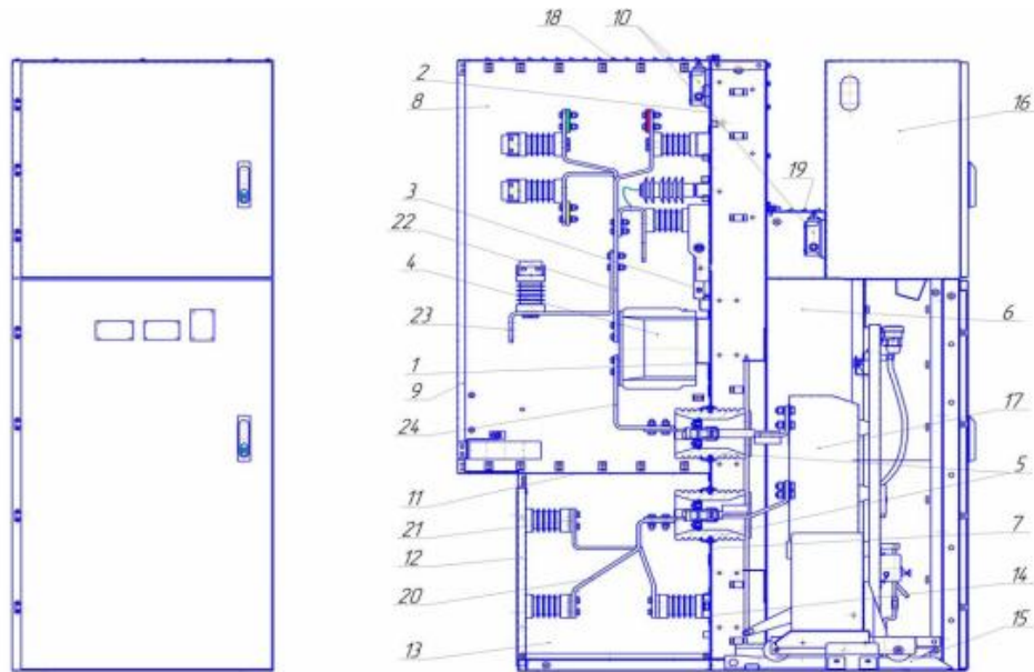
Рисунок 4.1 - Шкаф КРУ серии К-104М
