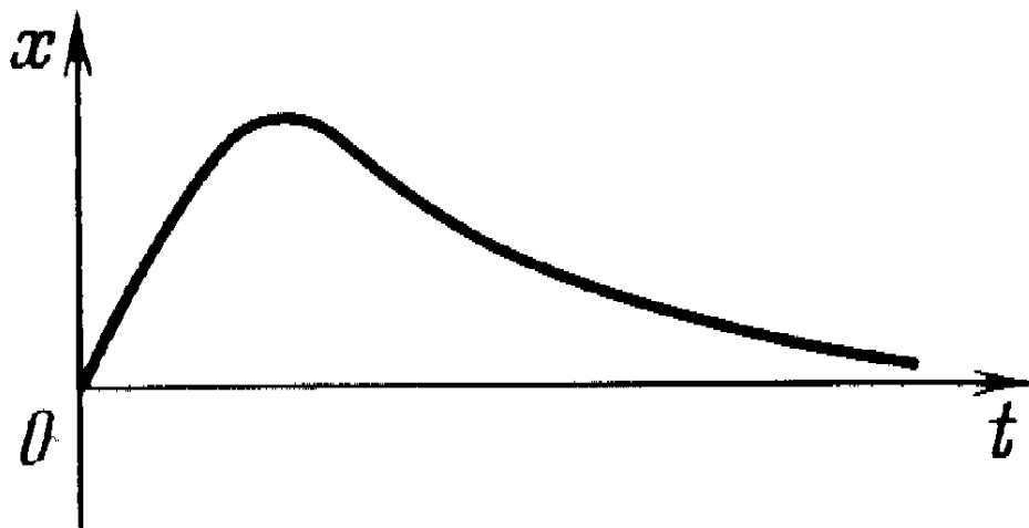
Рисунок 3.10 - Колебательный процесс при подключенном заземлении
