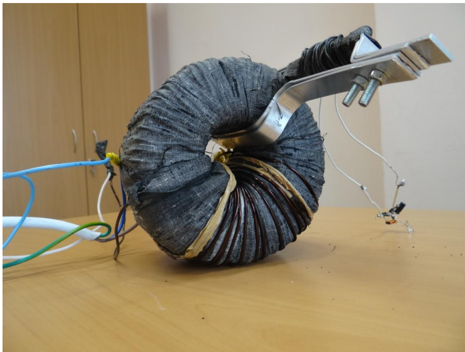
Рисунок 4.2. – Установка для эксперимента с датчиком тока
