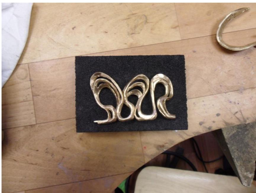
Рис. 16 Фотография отлитых в желтой бронзе деталей подставки
