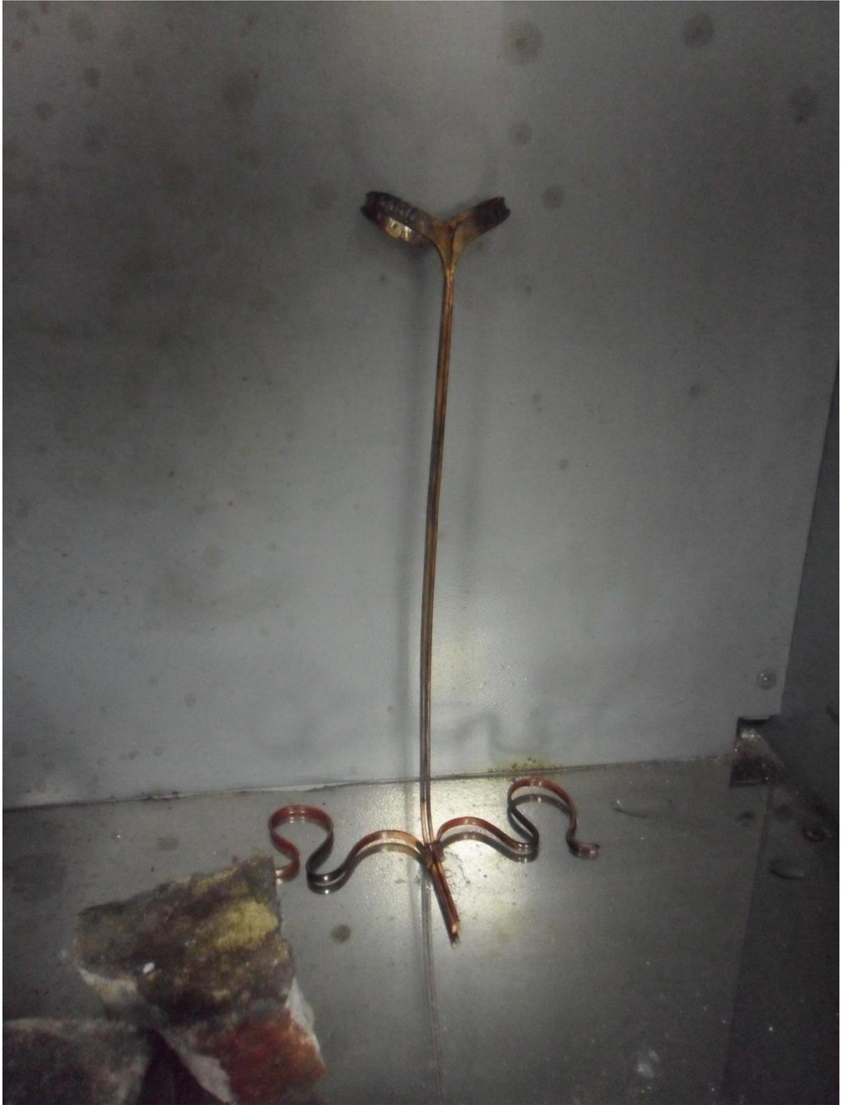
Рис. 29 Фотография подставки в процессе пайки
