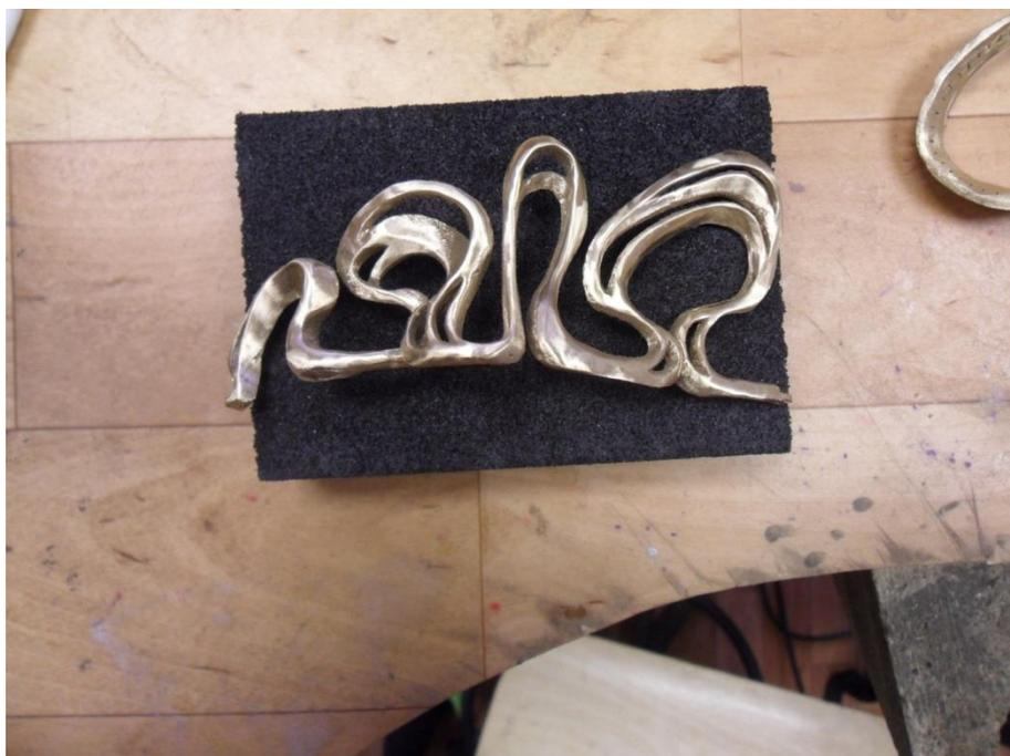
Рис. 18 Фотография отлитых в желтой бронзе деталей подставки
