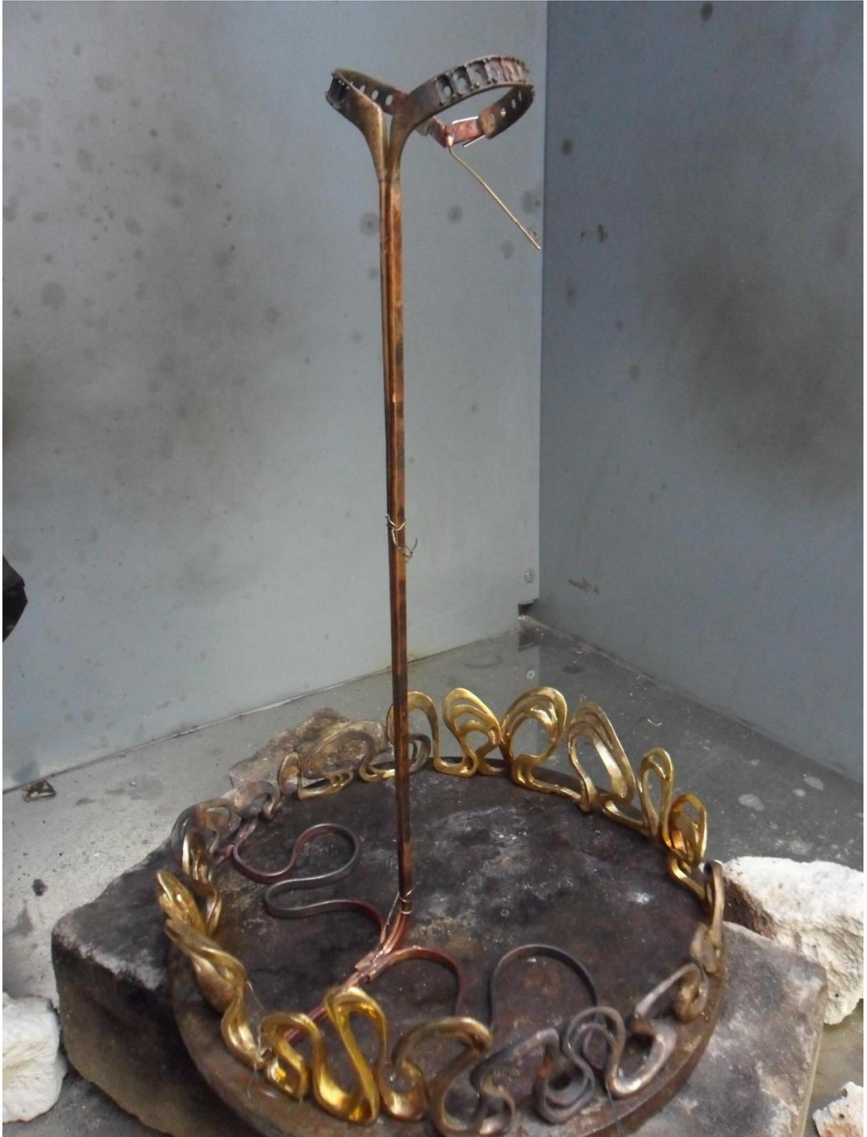
Рис. 30 Фотография подставки в процессе пайки
