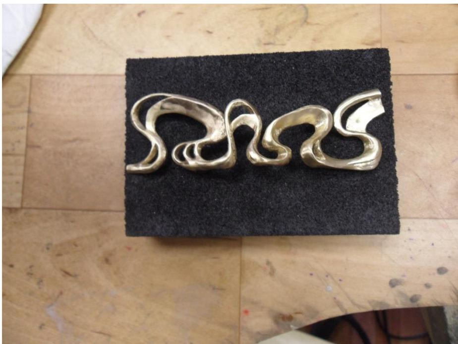
Рис. 17 Фотография отлитых в желтой бронзе деталей подставки
