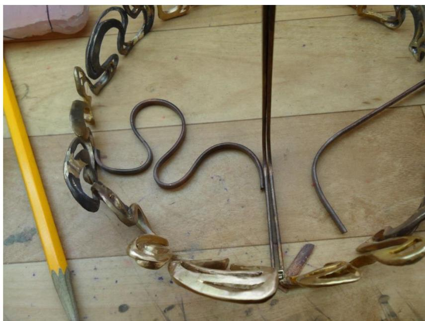
Рис. 28 Фотография бронзовой подставки перед пайкой с напайными
