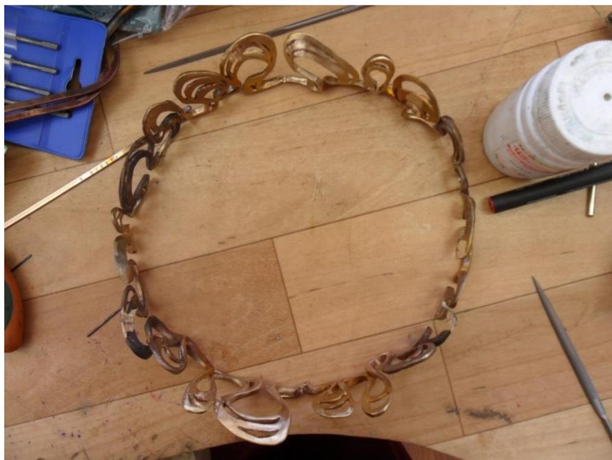
Рис. 27 Фотография бронзовой подставки перед пайкой, вид сверху
