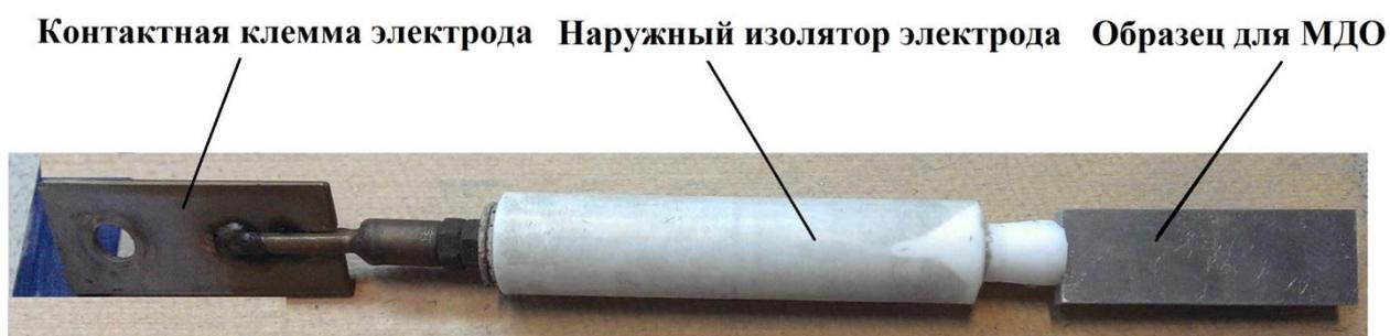
Рисунок 2.3 – Схема закрепления образца на электроде (а) и общий вид в сборе образца и оснастки для МДО (б)
