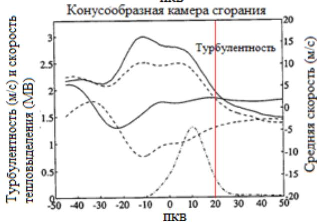
Рисунок 1.5.4 – Изменение составляющих средней и пульсационной скорости, скорости тепловыделения в зависимости от угла поворота коленчатого вала в камерах сгорания с повышенной степенью сжатия
