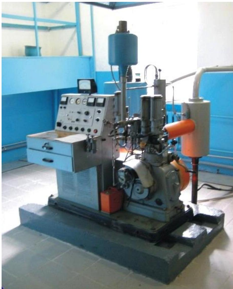
Рисунок 2.1.1 – Экспериментальная установка УИТ–85
