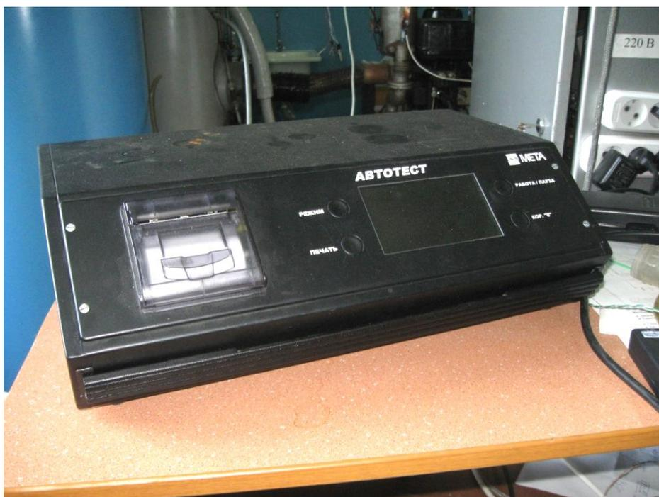
Рисунок 2.1.7 –газоанализатор фирмы Мета
