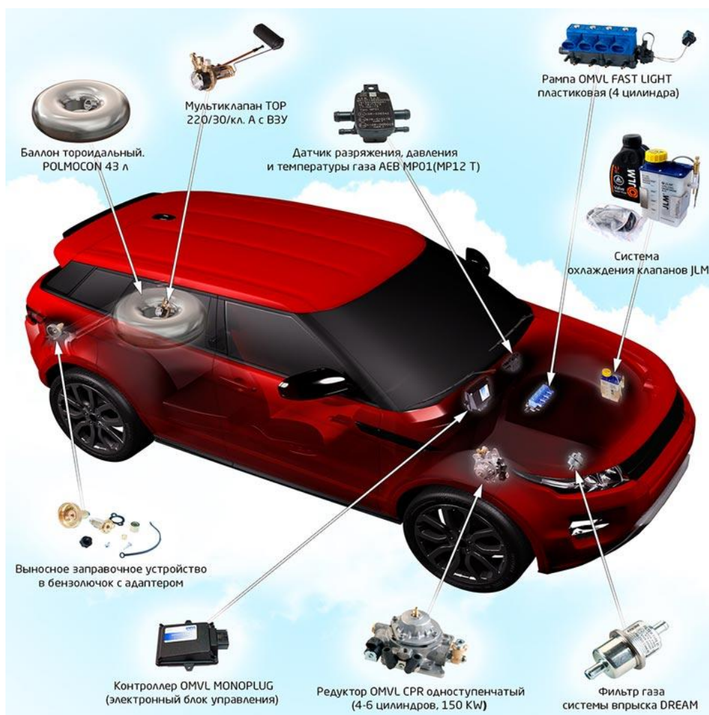
Рисунок 6.1 - Компоненты газобаллонного оборудования
