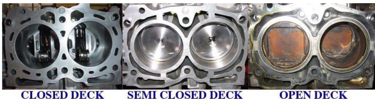
Рисунок 1.2 – Типы соединения рубашек охлаждения в ДВС
