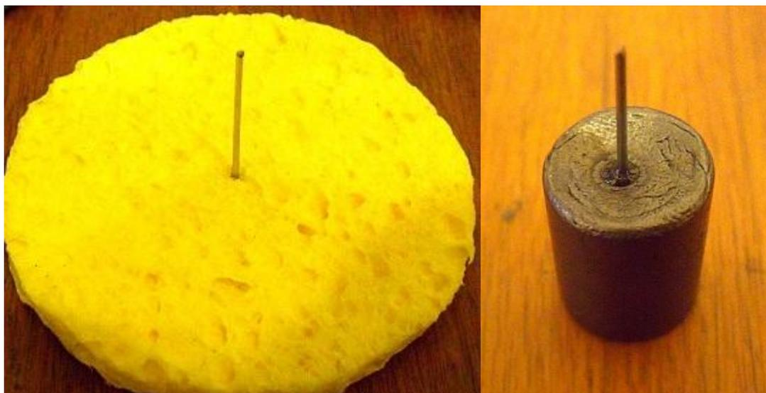
Рисунок 7 – Поршень вытеснитель и рабочий поршень
