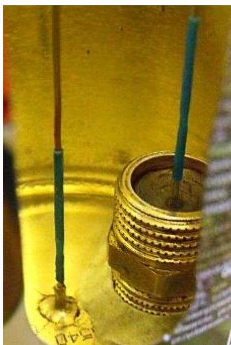
Рисунок 8 – Крепление штоков с шатунами при помощи расплавленной пластиковой ленты
