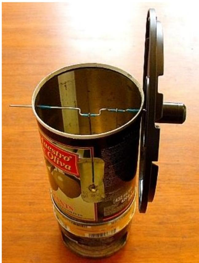
Рисунок 8 – Макет двигателя гамма типа, работающего по циклу Стирлинга
