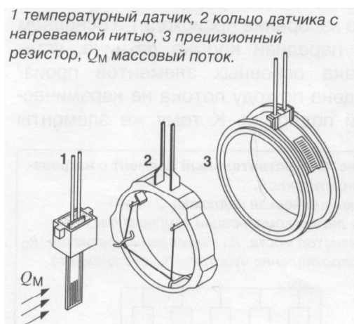
Рисунок 3.2 – Компоненты нитевого датчика массового расхода воздуха
