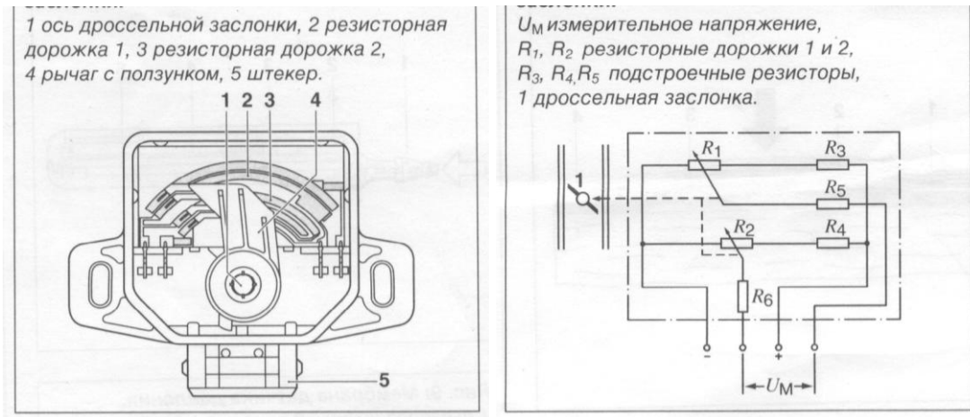
Рисунок 3.4 - Датчик положения дроссельной заслонки и схема его подключения
