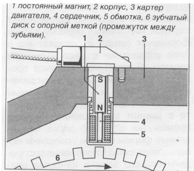
Рисунок 3.5 – Датчик частоты вращения
