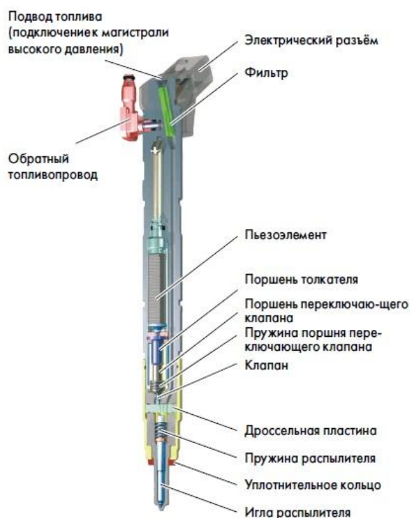
Рисунок 3. Пьезоэлектрическая форсунка.
