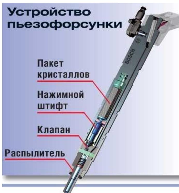
Рисунок 4.1 – Пьезофорсунка
