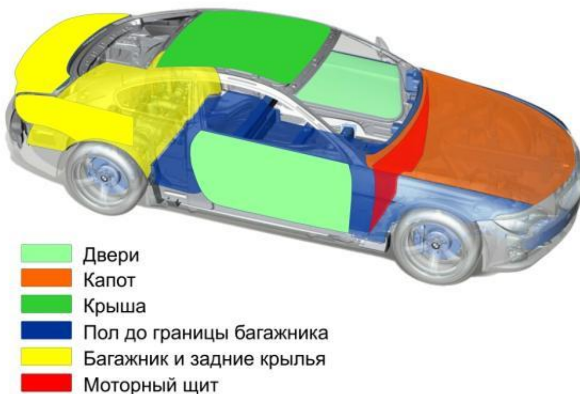
Рисунок 7.3 - Схема звукоизоляции автомобиля
