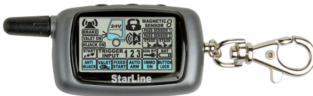
Рисунок 2 противугонное устройство с двухсторонней связью
