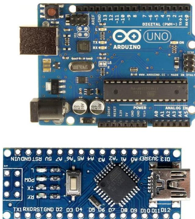
Рисунок 22 - платформы Arduino Uno и Arduino Nano.
