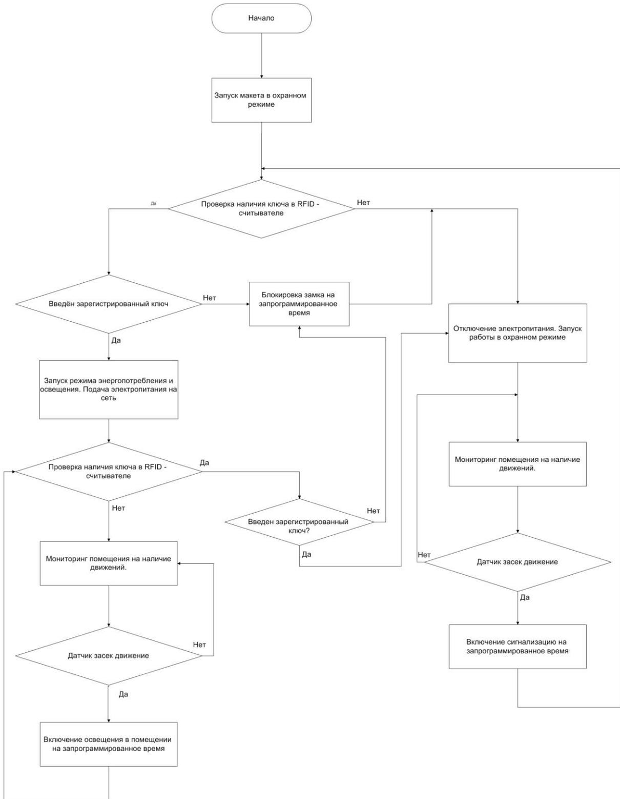
Рисунок 21 - Алгоритм работы макета системы «Умный дом» изображённый в виде блок-схемы программы.
