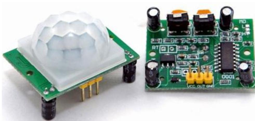
Рисунок 24 - инфракрасный датчик движения PIR HC-SR501.
