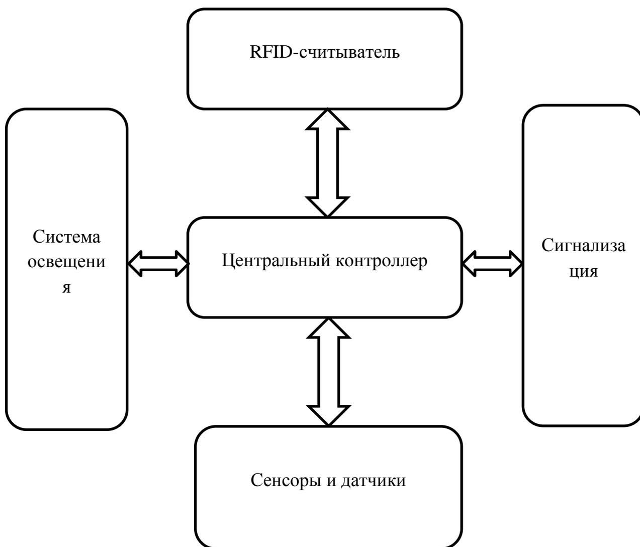
Рисунок 20 - архитектура системы, построенная мной на основе проанализированных данных.
