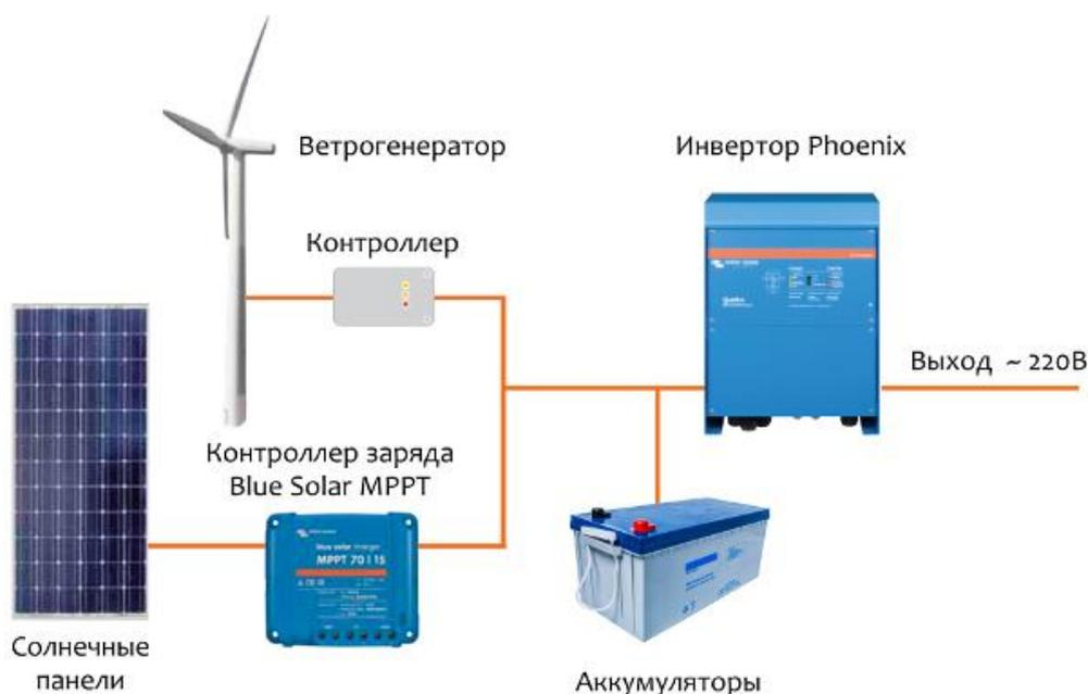
Рисунок 19 – Система автономного электроснабжения дома.
