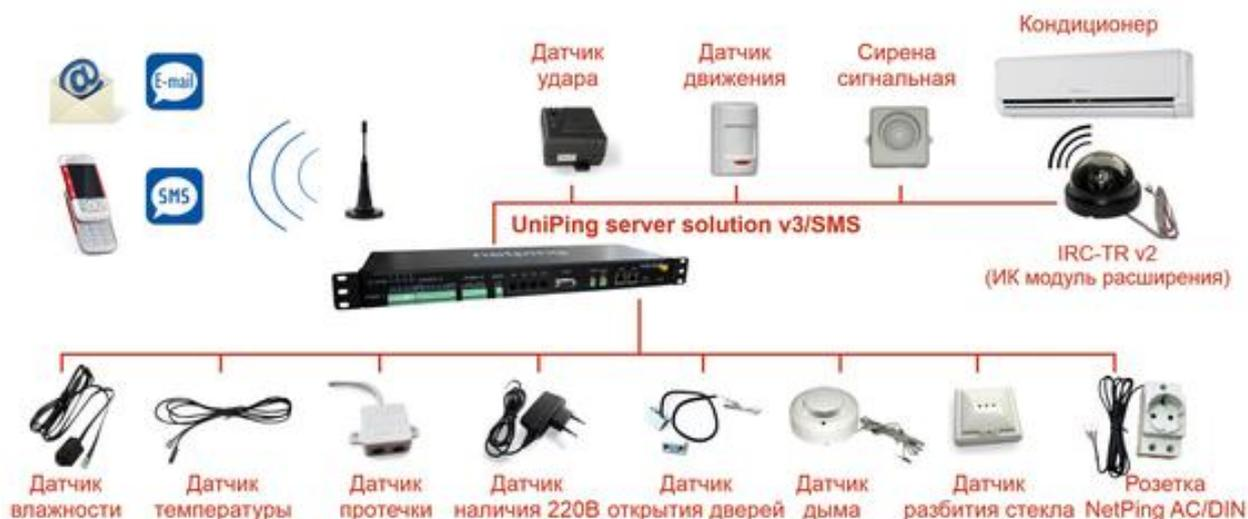
Рисунок 14 - Устройство удалённого мониторинга датчиков по сети Ethernet/Internet «UniPing server solution v3» включенная в структуру умного дома.
